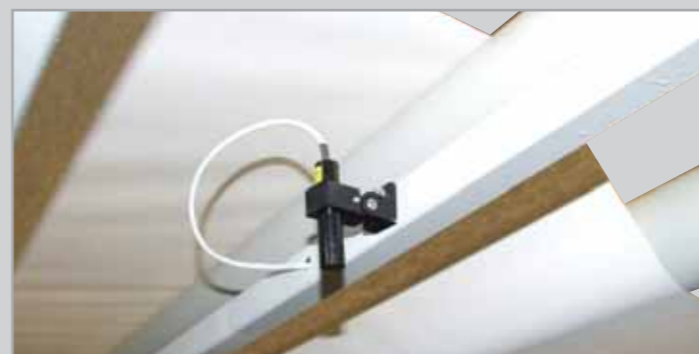
> Laser per allineamento carta - tessuto. > Allignment laser for paper - textile. > Láser para alineación de papel - tejido.
