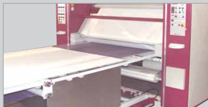
> Tavolo lungo di preparazione, in entrata macchina. > Long preparation table, in entry of the machine. > Mesa larga de preparación, a la entrada de la maquina.
